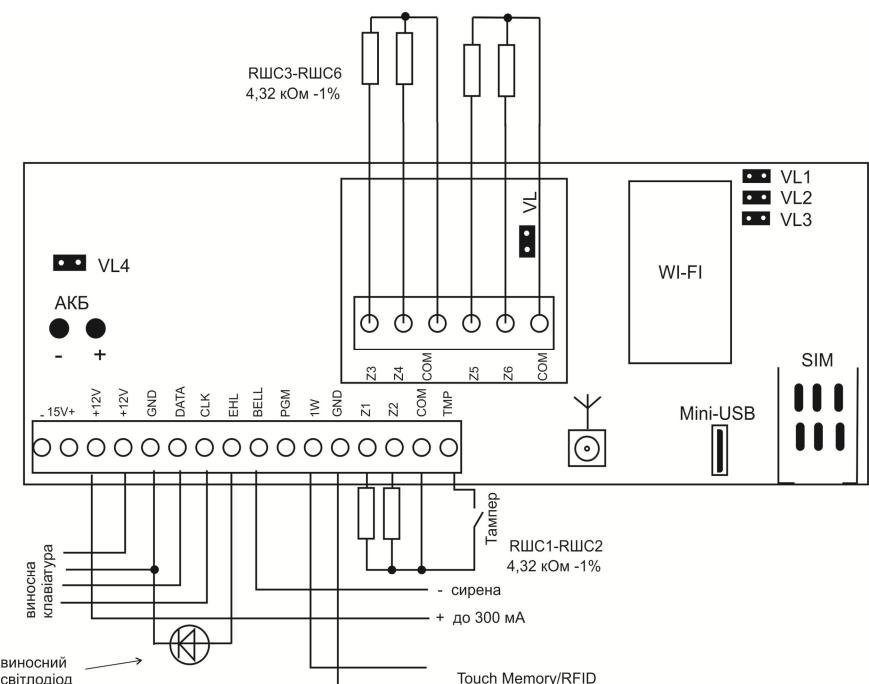
Схема підключення приладу (Мал. 1)
