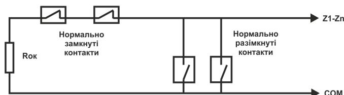
Схема підключення сповіщувачів з нормальними замкненнями та нормально розімкненими контактами (Мал. 2)
